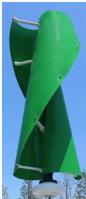
Cette éolienne de 1 kW, de type Helix, dont le but est essentiellement pédagogique, sera fixée prochainement.
